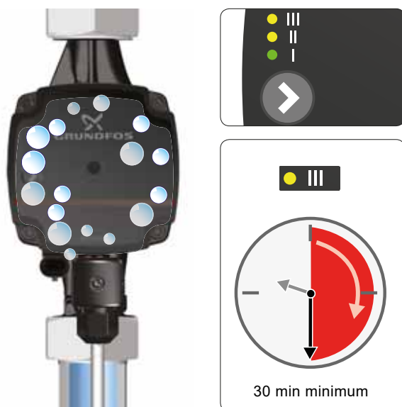
Fig. 7 Purge du circulateur
